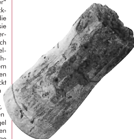
Durch den Korkwurm geschädigter Korken.
